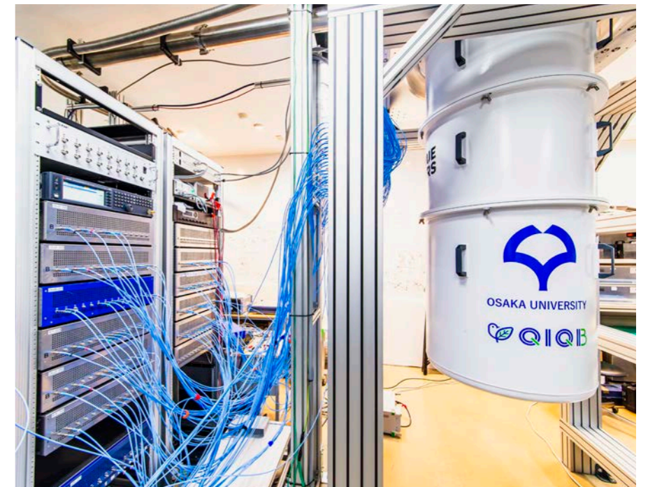
大阪大学の超伝導量子コンピュータ国産3号機を支えるキュエル製の制御装置(左)
